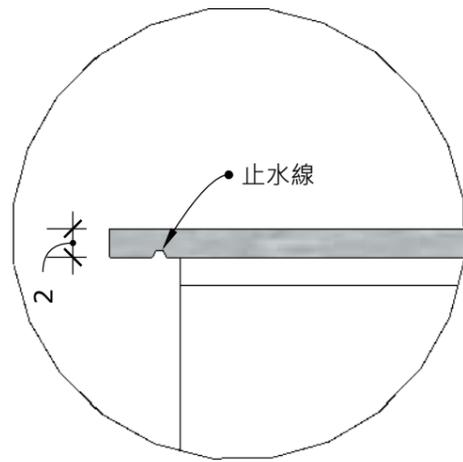
詳圖E: 不鏽鋼檯面施工大樣 比例: 1/5
